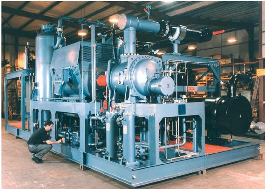
**ВСЕ КОМПРЕССОРЫ СЕРИИ WRV ИМЕЮТ КОНСТРУКЦИЮ С ДВОЙНЫМИ СТЕНКАМИ И ИСПОЛЬЗУЮТ ПОДШИПНИКИ СКОЛЬЖЕНИЯ ИЗ БАББИТА С ГЕРМЕТИЧНЫМ УПЛОТНЕНИЕМ ВАЛА.**
